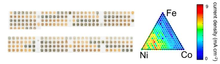
ITO基板上的酸化物(Ni,Fe,Co)O<sub>x</sub> 水電解での触媒活性
