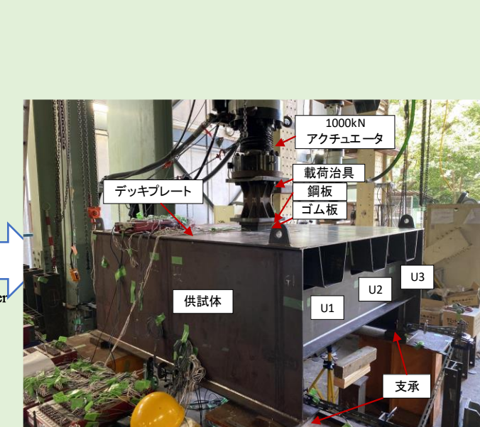
図8 鋼床版载荷実験
