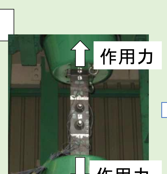
図5 スタッドボルト当て板疲労試験
